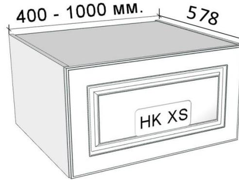
Шкафы глубиной 578 мм. шириной от 400 до 1000 мм. и высотой 300, 360, 400 и 460 мм.
