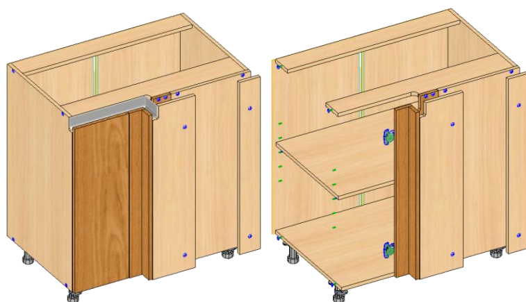
Рис.6 Схема каркаса. Стол (ФП50) угол. прямого.
