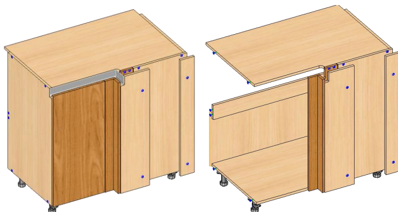
Рис.7 Схема каркаса. Стол (ФП50) угол прямой под МВ.
