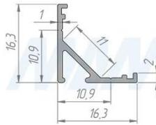
В состав профилей уже входит светодиодная лента. Цвет свечения: нейтральный белый 4000-4500К мощностью 9,6 Ватт на метр.
